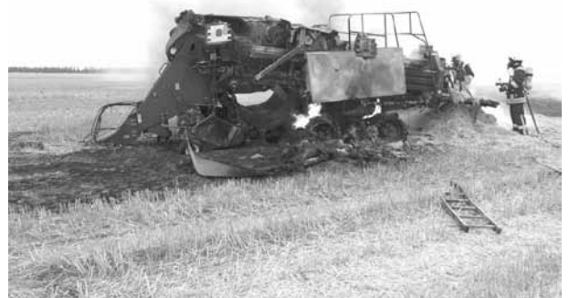
Löscharbeiten an der ausgebrannten Strohballenpresse
